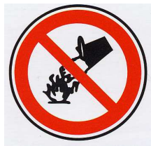
Interdit d'éteindre avec de l'eau
